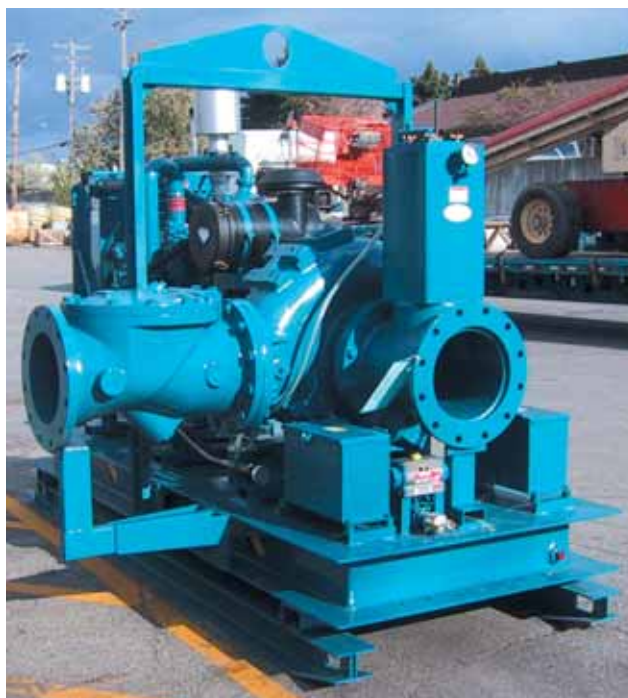
Pompe à eaux usées Thompson JSC de 12 po ouverte, à compresseur et auto-amorçage à sec.
