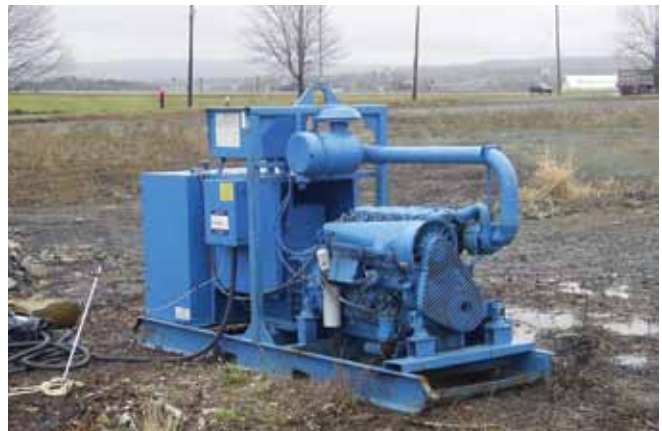
Tuyau galvanisé en acier Kwik-Lok de 12 po et générateur Flygt de 100 kW.
