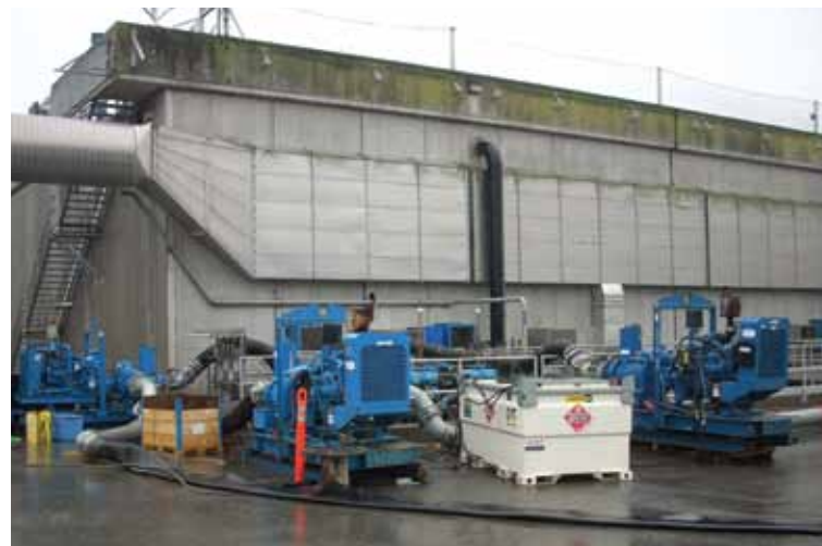
Pompes à moteur diesel Thomson sur plate-forme avec système ENVIROPRIME® et réservoirs de carburant.
