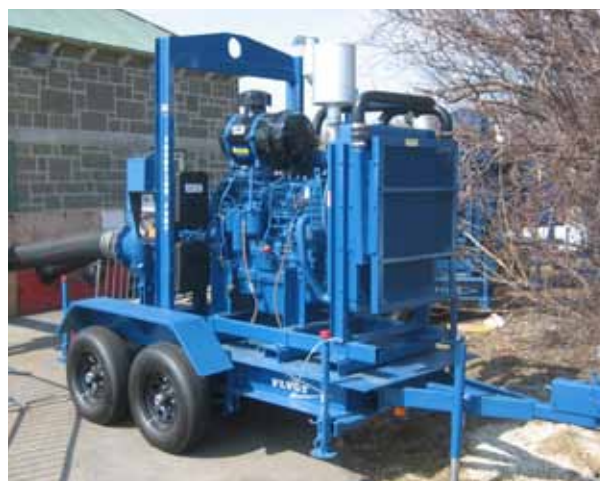
Pompe Thompson modèle 12JSCG-DJDST-81H-M montée sur remorque à amorçage automatique.
