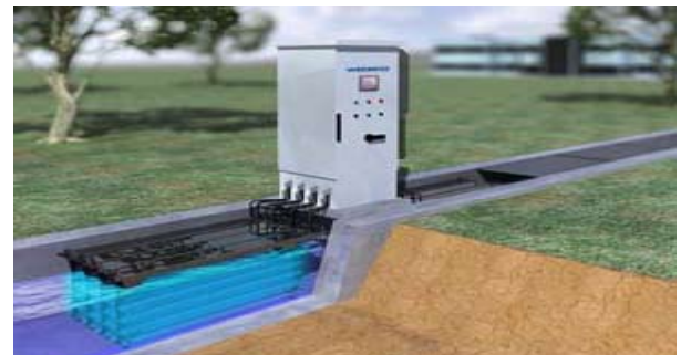
Des modules efficaces de lampes UV à basse pression assurent la désinfection des eaux usées dans une canalisation à écoulement libre.
