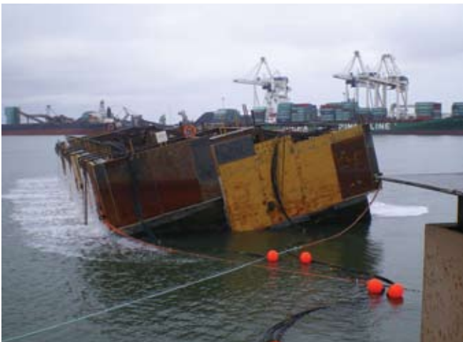
Les câbles d'alimentation étaient réunis en faisceau et fixés à des bouées.
