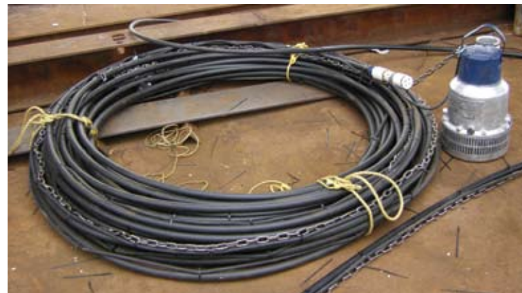
Une pompe BS 2125 et un câble de 400 pi commandé pour l'occasion.
