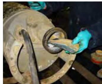
Restes de matériau de remblayage durci (retiré lors de l'entretien de la pompe).
