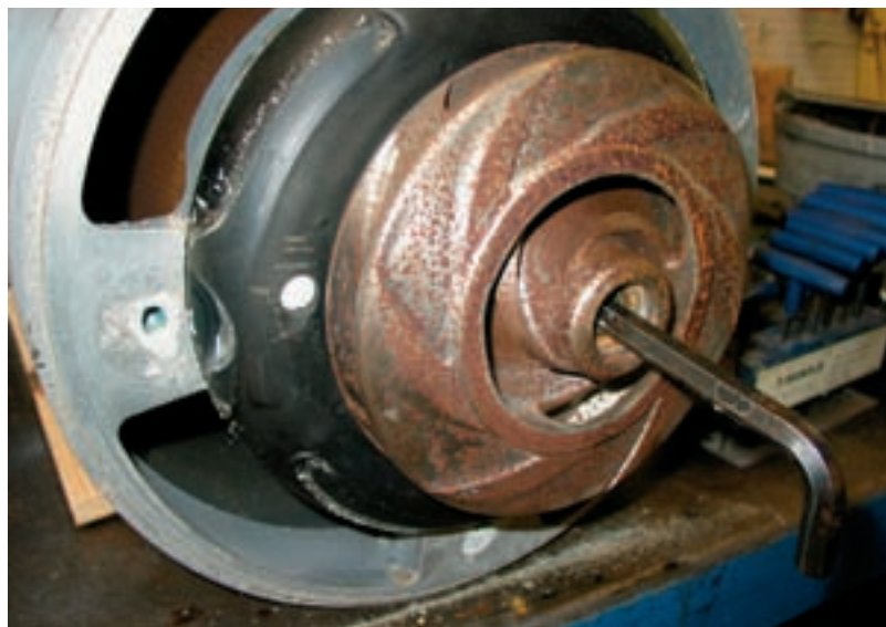
La partie humide ne présente pas de trace d'usure une fois le travail terminé, et il est très facile de réajuster le rotor.
